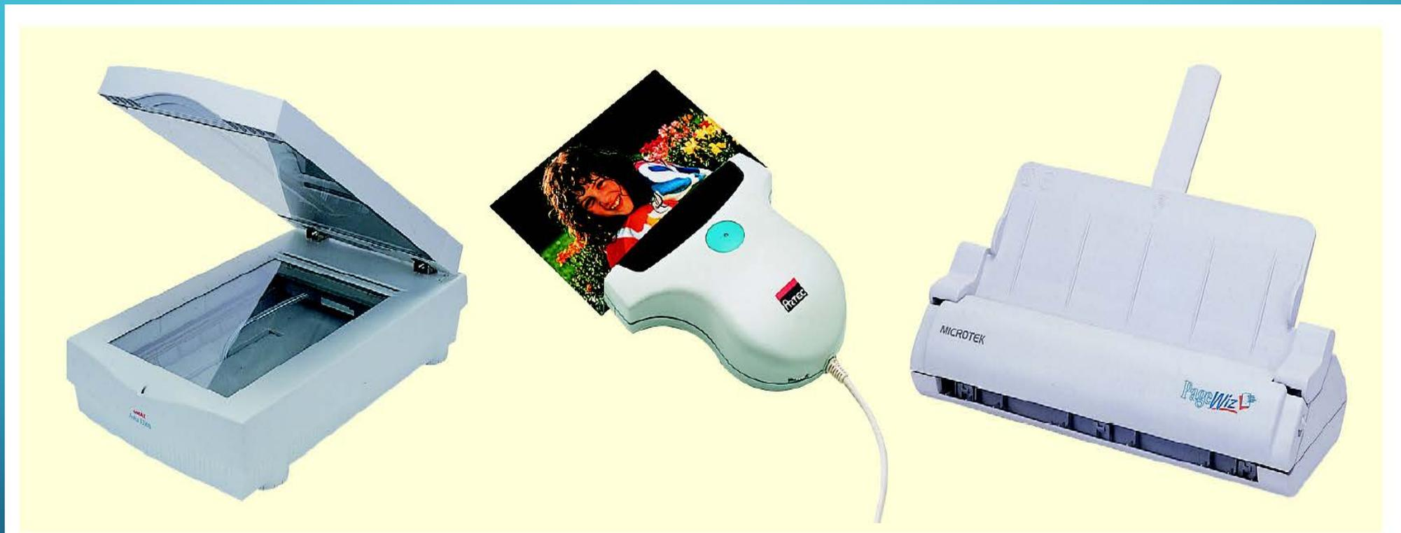
圖 4-19 平台型掃描器、掌上型掃描器、饋紙型掃描器
